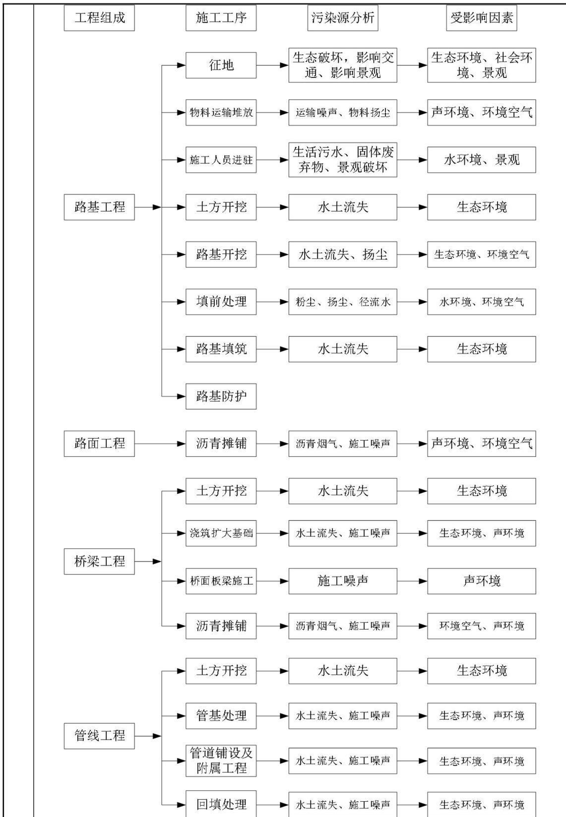
图 2-8 道路项目施工期流程图及产污环节分析
