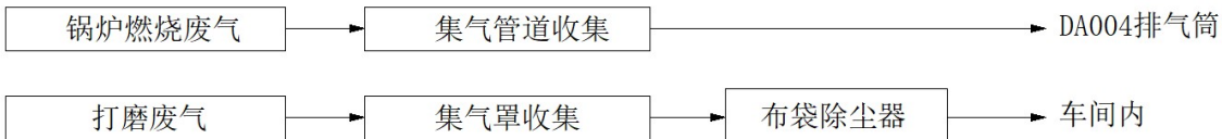
图 2-12 现有项目废气收集处理流向图
